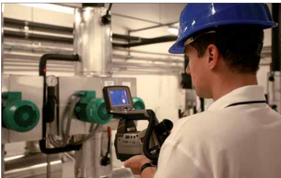
Technik provádějící termovizní měření
