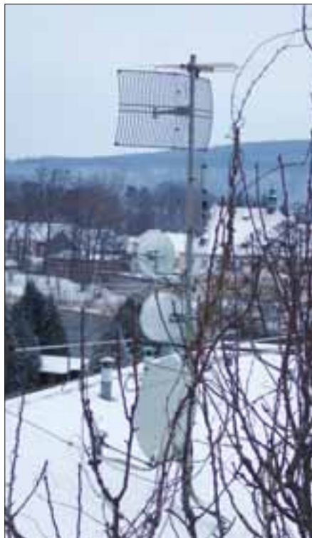
Překážky mezi anténou a přístupovým bodem snižují kvalitu připojení Autor: M. Nešpor
